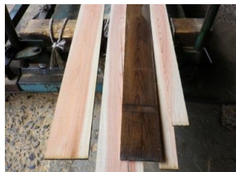
変色した板材を 削ったもの
